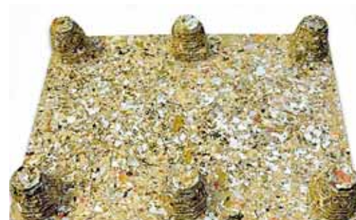
Prototyp einer „LAP“-Recyclingpalette, für deren Herstellung neben Altholz der Kategorien A1 bis A3 auch nicht trennbare Sekundärrohstoffe wie PET-Flaschen oder Verbundstoffe von Getränkeverpackungen zum Einsatz kommen. Fotos: LAP
